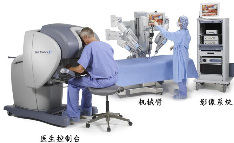
图 4-4 腹腔镜手术机器人系统组成（以达芬奇手术机器人为例）
